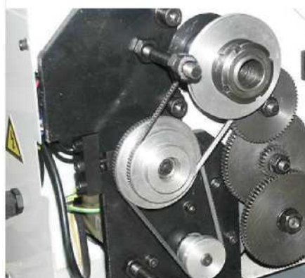
Рис. 3-8: Изменение положения приводного ремня
