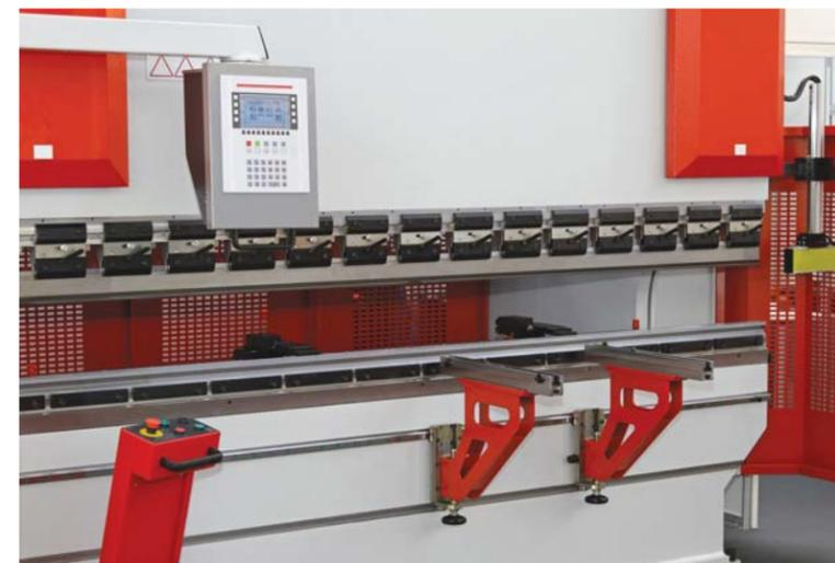
за счёт технологии распределения усилий клапаном пропорциональности в гидравлической системе. Идеально, если точность синхронизации двух гидроцилиндров составляет 0,01 мм.
