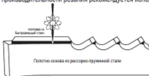
Полотно-основа представляет собой легированную улучшенную сталь с высоким пределом упругости. Вершина зуба изготавливается из быстрорежущей стали качествен M42, M51.
