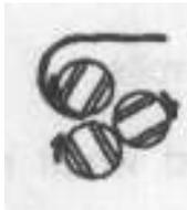
6. ПЕРЕДНИЙ И ЗАДНИЙ РЕГУЛИРОВОЧНЫЕ ВИНТЫ - Четыре регулировочных винта (два расположены спереди, два - сзади) встроены в левую и правую стойки рамы.
